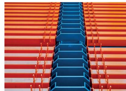
Die Besonderheit des Lagersystems ist die Größe der Systempaletten. Es können Bleche im Format von bis zu 2.600 x 6.100 mm und einem maximalen Gewicht von 5.000 kg eingelagert werden.
